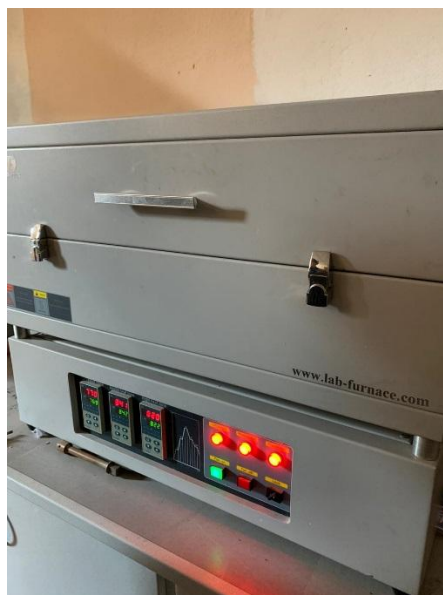
Сурет 3.18 - Үш зоналы көлденең пешті қыздыру процесі.
