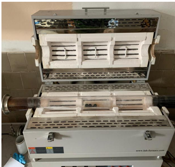
Сурет 3.17 - Үлгілерді үш зоналы құбырлы пешке салыңыз.
