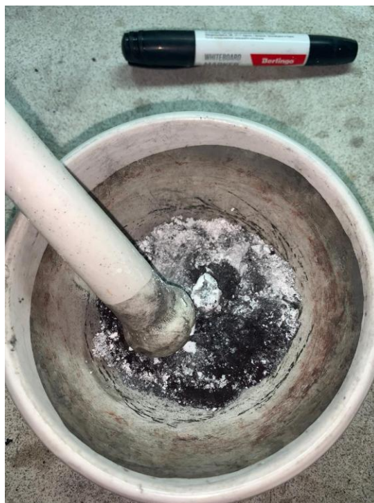
Сурет 3.13 - Фарфор ерітіндісінде үлгілерді жылжыту процесі
